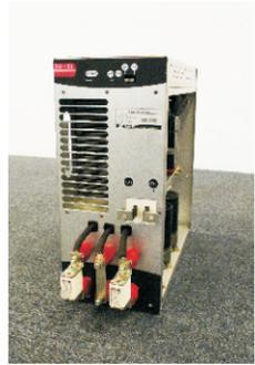
SBH系列高压变频器的功率单元由三相全桥整流桥、滤波电容、IGBT（绝缘栅双极型晶体管）、控制板等电气部件构成，其结构与“三相输入，单相输出”的“交-直-交”逆变结构低压变频器相同。由于每个功率单元结构以及电气性能上完全一致，可以互换，便于检修、判断单元是否故障。单元串联结构决定了SBH系列高压变频器很容易实现模块化设计，适合大批量生产，形成产业规模。
