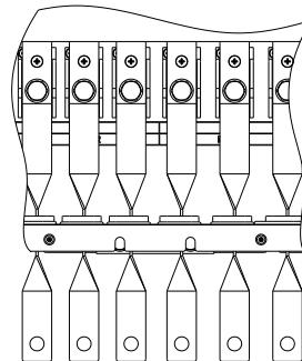
扭曲铜排在整机上接线效果示意图
