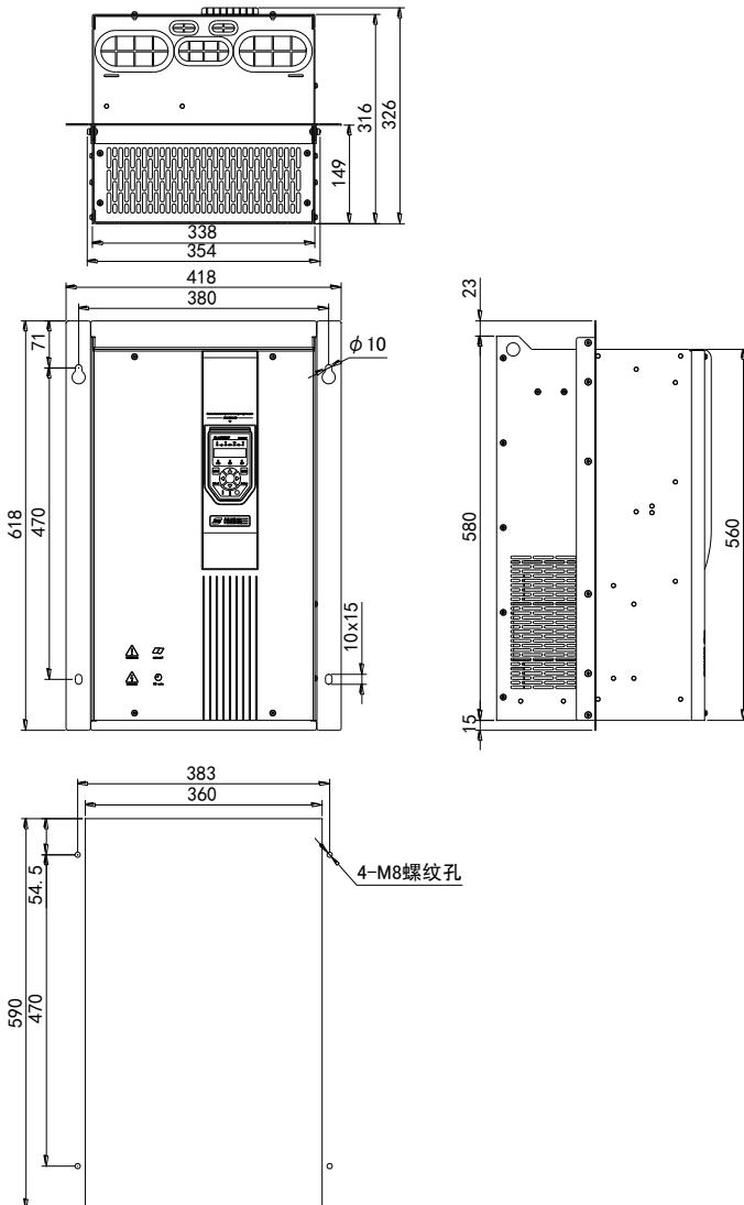
H510-A-5 安装挂条及开孔尺寸示意图
