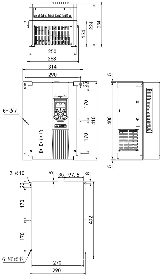
H510-A-3 安装挂条及开孔尺寸示意图
