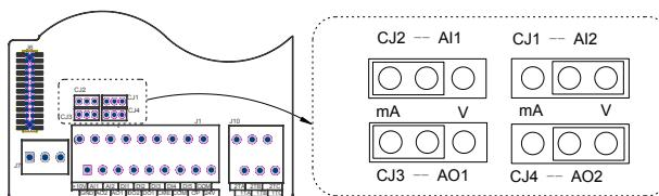
Hope530G系列控制板端子排列（建议使用1mm<sup>2</sup>的铜导线）：
