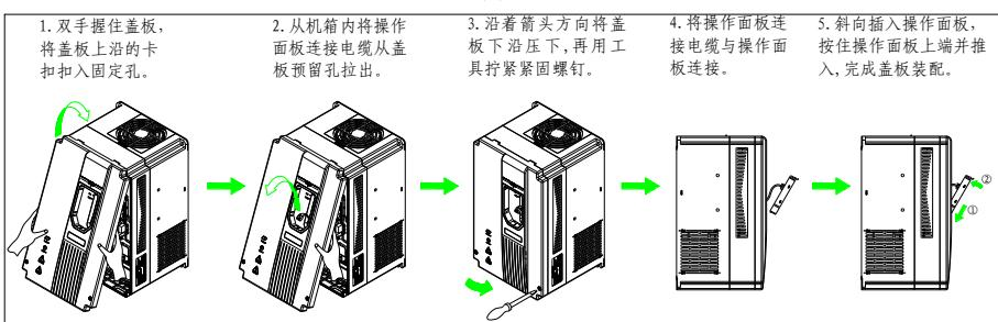
图 3-11 Hope530G11T4~Hope530G37T4 机型盖板拆卸与安装步骤
