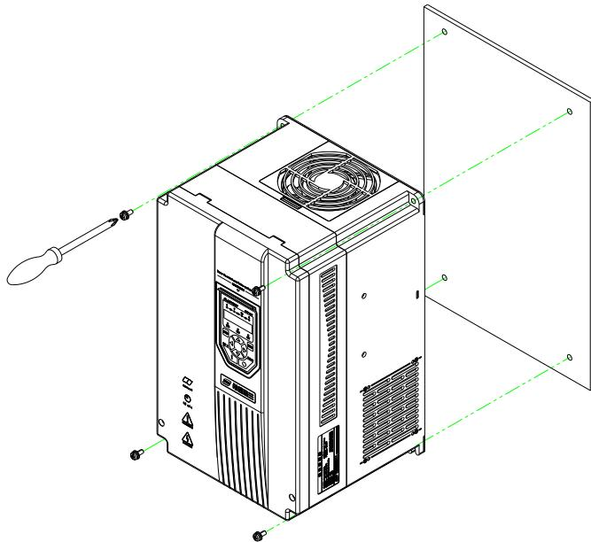
图 3-6 Hope530G0.75T4~Hope530G37T4 机型壁挂式安装
