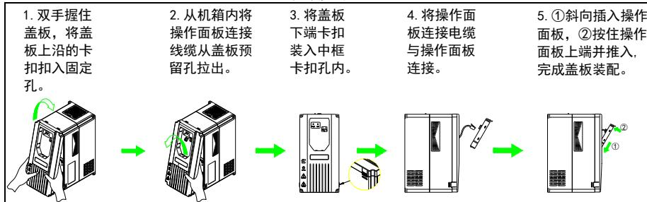
图 3-10 Hope530G0.75T4~Hope530G7.5T4 机型盖板拆卸与安装步骤
