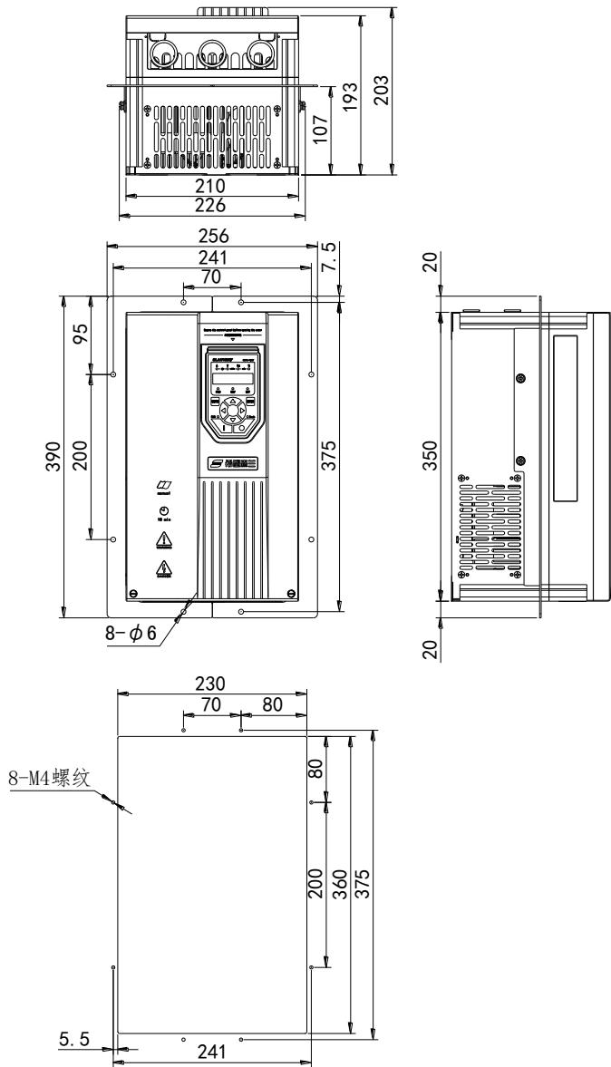
H510-A-2 安装挂条及开孔尺寸示意图
