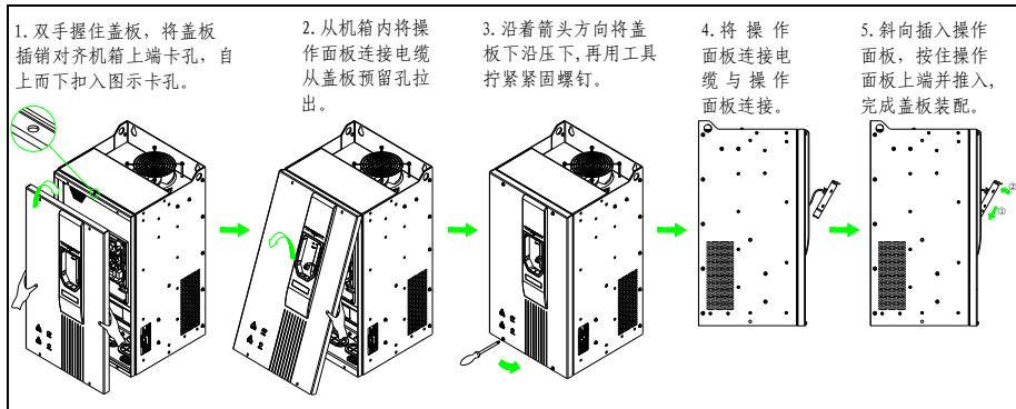
图 3-12 Hope530G45T4~Hope530G375T4 机型盖板拆卸与安装步骤
