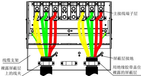
在Hope530G45T4~Hope530G375T4机型主回路端子接线图中的线缆支架是选配件，需另行购买，其安装步骤如下：
