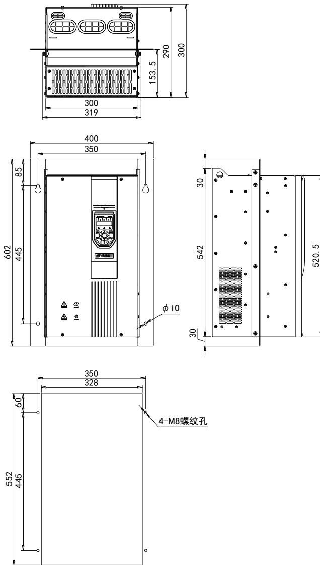
H510-A-4 安装挂条及开孔尺寸示意图
