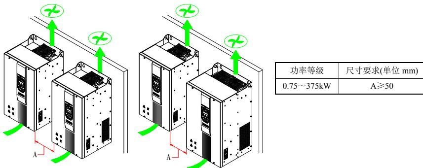
图 3-3 Hope530G0.75T4~Hope530G375T4 多台机器并排安装
