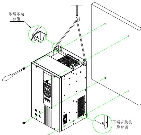
图 3-7 Hope530G45T4~Hope530G375T4 机型壁挂式安装
