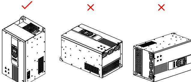
图 3-5 安装方向示意图
