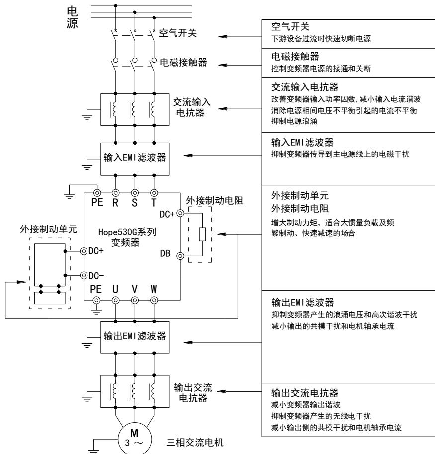
图3-14 Hope530G系列变频系统连接示意图
