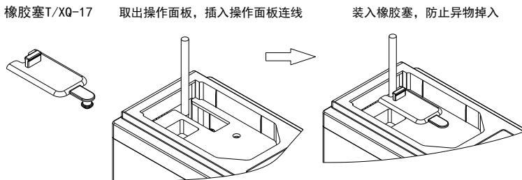
图3-13 Hope530G0.75-7.5T4B(L)操作面板外引时橡胶塞装配示意图
