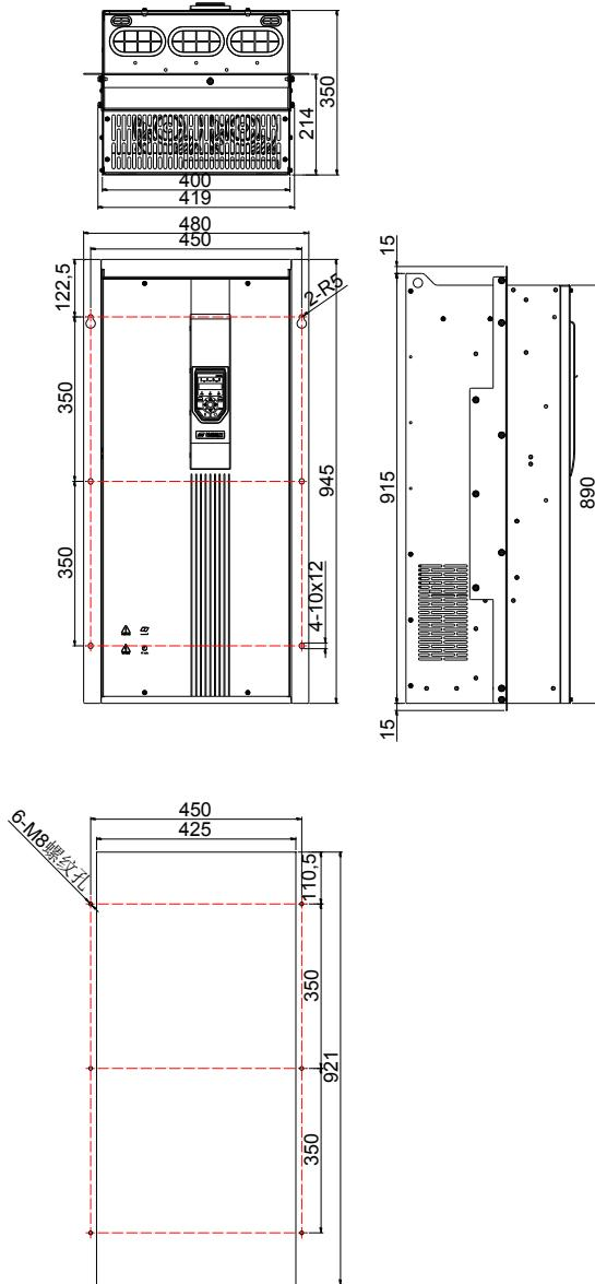
H530-A-6 安装挂条及开孔尺寸示意图
