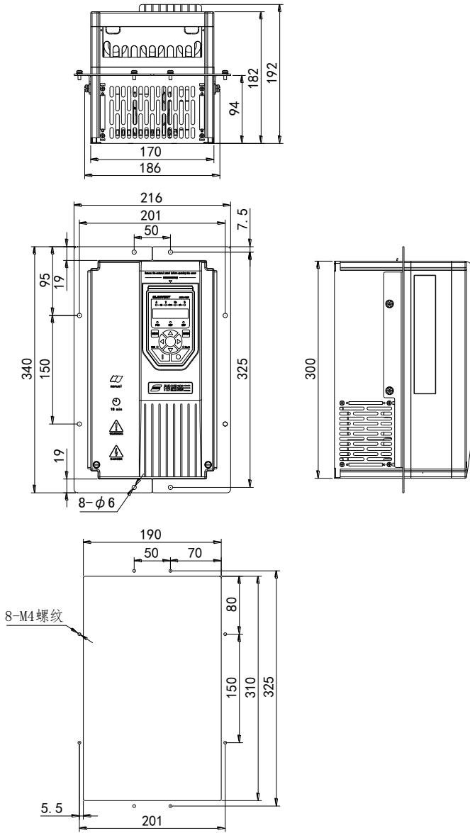
H510-A-1 安装挂条及开孔尺寸示意图
