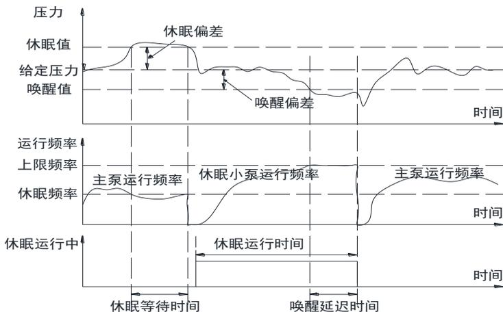
☐ 过程 PID 休眠唤醒后的起动方式由 Fb-25 “瞬停、自复位、运行中断再起方式” 和 F1-19 “起动方式” 决定, 建议在不允许反转的场合使用从起动频率起动。
