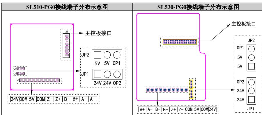
安装方法：（1）确认变频器断电；（2）按照编码器安装示意图安装编码器信号转接板；（3）按照编码器接线示意图所示的方法将编码器扩展板与控制板连接起来。
