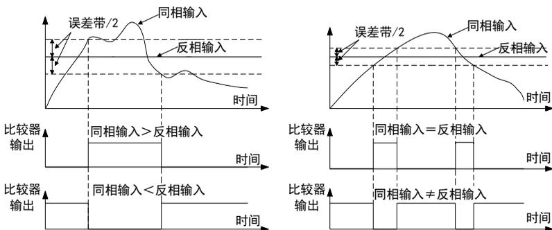
变频器可用两个信号比较的结果当作变频器保护动作的触发信号，通过“比较器配置”的百位选择需要的保护动作。
