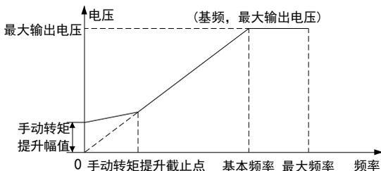
□ 自动转矩提升可以根据负载电流的大小实时改变电压的值，补偿定子阻抗的电压损失，自动适应各种负载情况，输出合适的电压，实现在重载下有较大的输出转矩和空载时有较小的输出电流。
