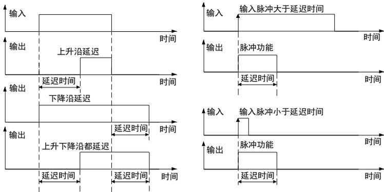
☐ 用定时器可以完成信号的消抖，例如上升沿延迟功能，当输入脉冲小于延迟时间时无输出。
