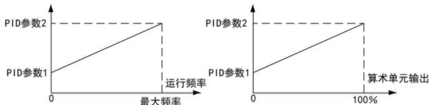
PID 参数调整原则: 先将比例增益从较小值 (如 0.20) 增大直至反馈信号开始振荡, 然后减小 40~60% 使反馈信号稳定; 将积分时间从较大值 (如 20.00s) 减小直至反馈信号开始振荡, 然后增大 10~50% 使反馈信号稳定。如果系统对超调和动态误差要求较高, 可以加入微分作用。
