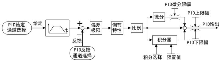
过程PID还有三种修正工作模式：加减速斜坡前的给定频率修正、加减速斜坡后的给定频率修正、转矩修正。这几种修正工作方式可以使变频器方便地用于主从同步或张力控制的场合。
