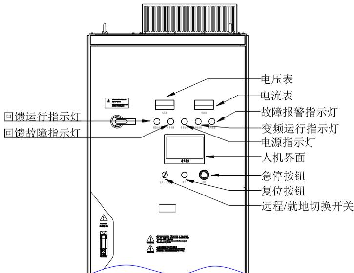
电源指示灯：表示输入电源已上电。
