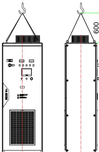
搬运：搬运过程中，要防止变频器受到撞击和震动，柜体不得倒置，倾斜角度不得超过 $30^{\circ}$ 。为了防止柜体变形，吊绳与柜体之间的夹角不得小于 $60^{\circ}$ ，见上图。吊装时要特别小心，以防碰坏或划伤柜体。
