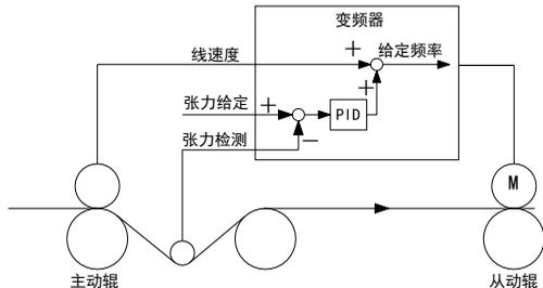
**加减速斜坡后的给定频率修正：**PID输出叠加在加减速斜坡后的给定频率上，与“加减速斜坡前的给定频率修正”的方法相比，可以在加减速过程中也起修正作用。
