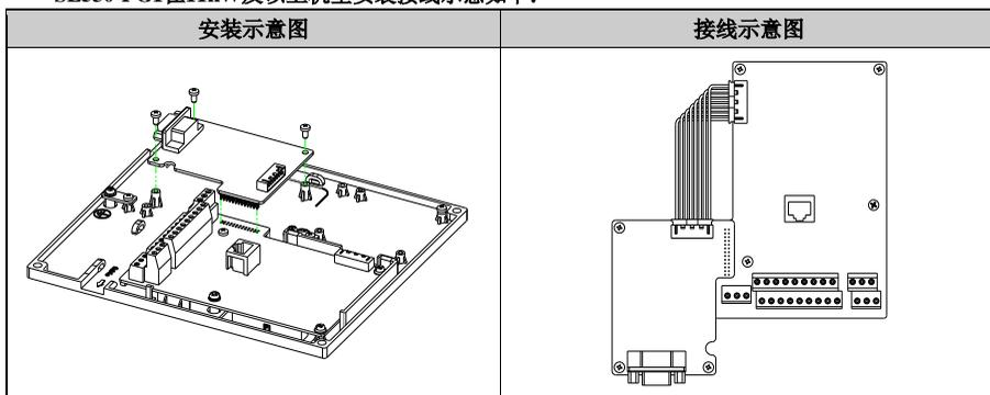
SL530-PG0在7.5kW及以下机型安装接线示意图如下（SL530-PG0无需额外与控制板接线）：
