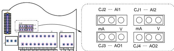
Hope560G系列控制板端子排列（建议使用1mm的铜导线）：
