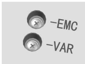
铁壳机箱限位螺钉示意图
