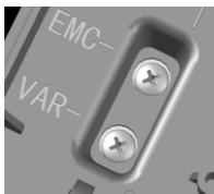
塑壳机箱限位螺钉示意图
